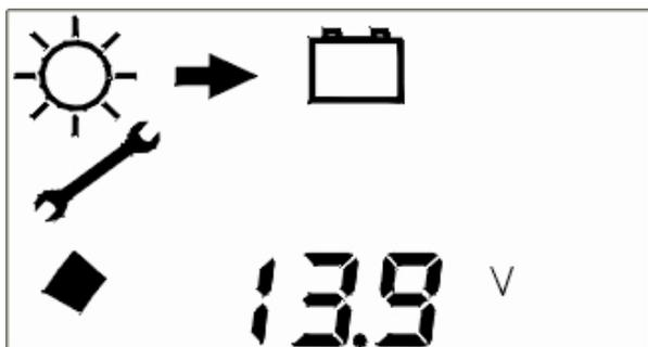
Nach Betätigung beider Tasten für 3s wird das Untermenü geöffnet. Der erste Balken auf der linken Seite zeigt die Einstellung der Float-Ladespannung an. Mit der rechten Taste kann der Wert angewählt und mit der linken Taste geändert werden.
