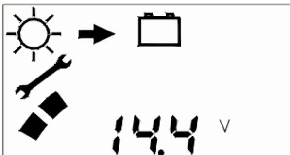
Nach Betätigung der linken Taste erscheint der zweite Balken und der Wert der Boost-Ladespannung. Mit der rechten Taste kann der Wert angewählt und mit der linken Taste geändert werden.
