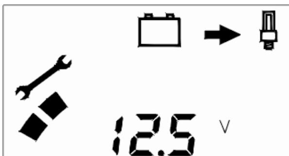
Nach erneuter Betätigung der linken Taste wird die Einschaltspannung des Tiefentladeschutzes angezeigt. Mit der rechten Taste kann der Wert angewählt und mit der linken Taste geändert werden.
