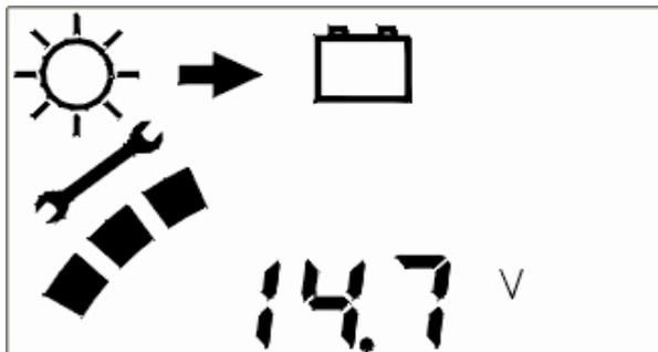
Nach erneuter Betätigung der linken Taste erscheint der dritte Balken und der Wert der Equal-Ladespannung. Mit der rechten Taste kann der Wert angewählt und mit der linken Taste geändert werden.
