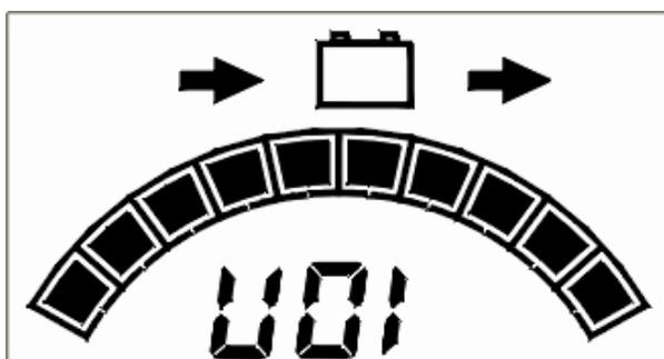
Nach betätigen der linken Taste für 3s wird das Menü für die grundlegenden Einstellungen geöffnet. Es erscheint der Menüpunkt Betriebsart.
