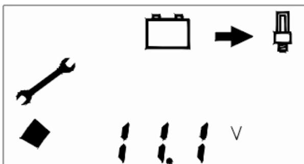
Nach erneuter Betätigung der linken Taste wird die Abschaltspannung des Tiefentladeschutzes angezeigt. Mit der rechten Taste kann der Wert angewählt und mit der linken Taste geändert werden.
